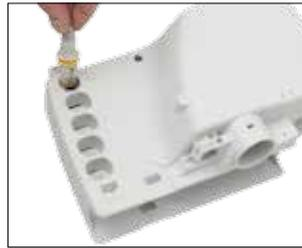
2. ハンドコントローラーに繋がるケーブルを抜きます。を抜き取ります。
